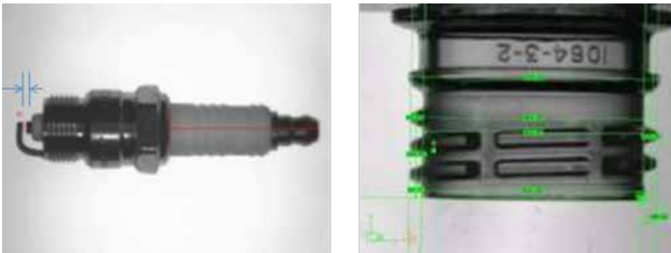
图7. 在测量应用中，机器视觉系统的元件测量公差可以保持在0.0254mm以内。
