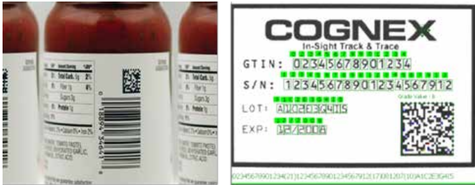
图6. 识别方法有很多，包括简单的条码扫描，还有先进的OCR技术。
