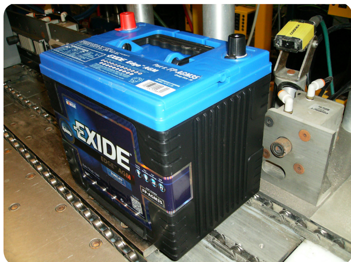
DataMan读码器在电池进入漏电测试站之前读取电池上的代码。
