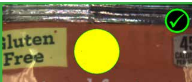
彩色像素计数工具通过识别感兴趣区域内经过培训的彩色像素值来确认包装的完整性。
